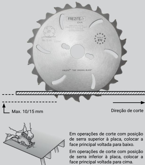
Em operações de corte com posição de serra superior à placa, colocar a face principal voltada para baixo.
